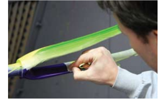
Les peintures sur les cadres sont réalisées à l'aide de pochoirs permettant une totale personnalisation. Paint schemes are completed via stencils, allowing for complete personalization.
