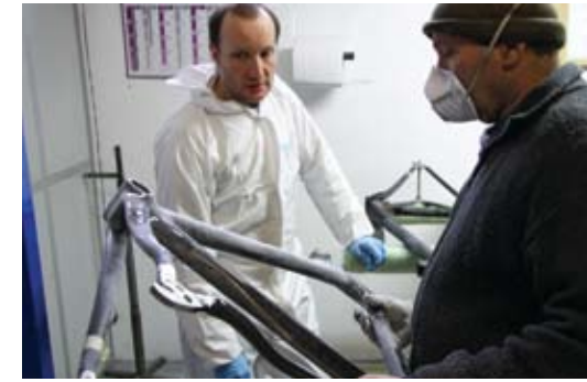
Chaque cadre CYFAC est préparé minutieusement avant d'être émaillé. Each CYFAC frame is meticulously prepared before painting.
