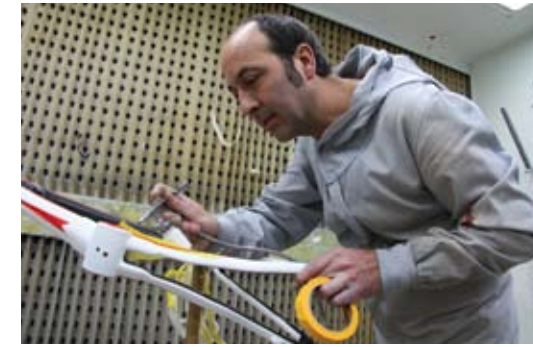
Chaque cadre CYFAC nécessite une étape minutieuse de retouches peintures à l'aérographe. Each CYFAC frame undergoes a stage of fine air-brushed detail.
